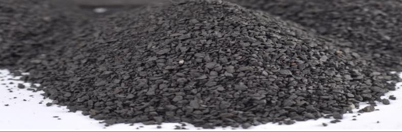
**Budući da bakarni grit sadrži visoku koncentraciju gvožđe-oksida, ovaj materijal poseduje znatnu čvrstoću i fleksibilnost. Zrna grita se manje troše prilikom rada i ne raspadaju se prilikom udara u površinu.**
