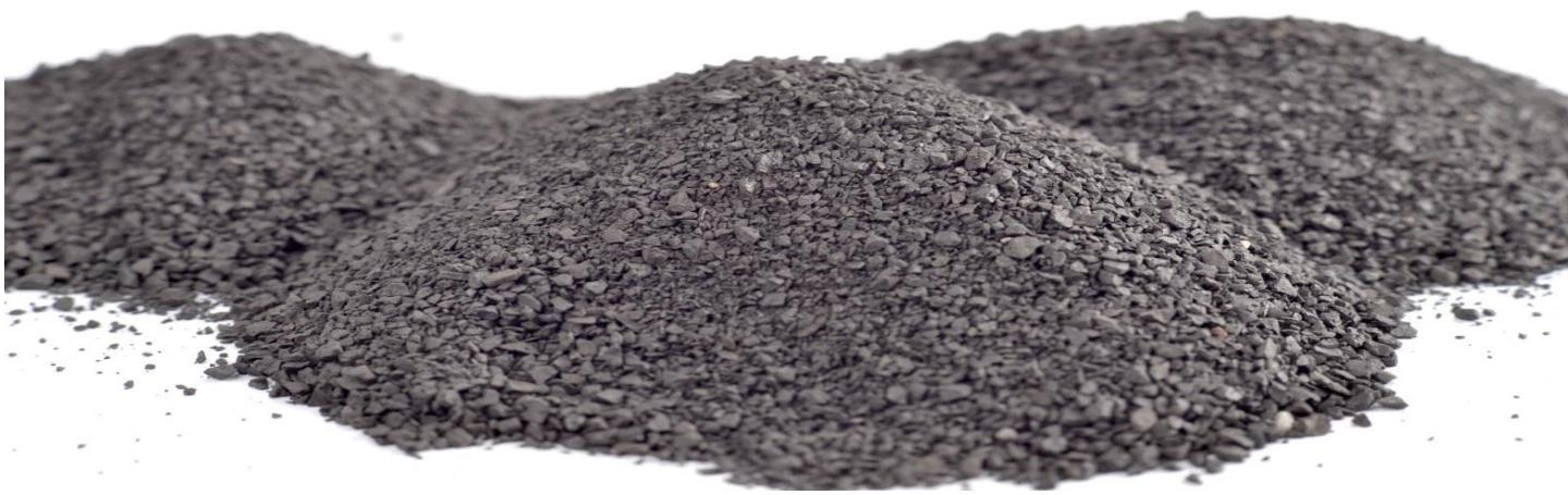
**Copper Slag-Grit** je abrazivni materijal za peskiranje napravljen od granulisane šljake dobijene tokom procesa topljenja bakra.
